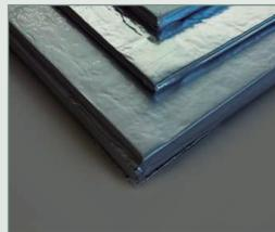
Los paneles de aislamiento en vacío U-Vacua™ constan de un núcleo de fibra de vidrio cubierto por un laminado de varias capas de distintos materiales, como nailon, aluminio y una capa protectora. La presión interna se reduce a un vacío de 1-20 Pa, minimizando así la conductividad térmica.
