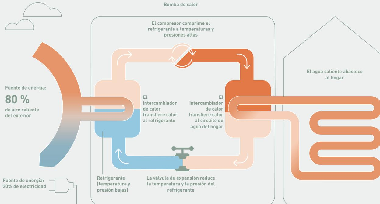
Aquarea extrae hasta un 80 % de la energía térmica necesaria del aire ambiente. Aquarea capta la energía térmica del aire ambiente y la transfiere para calentar el hogar y disponer de agua caliente sanitaria e incluso para refrigerar la casa si se desea.
